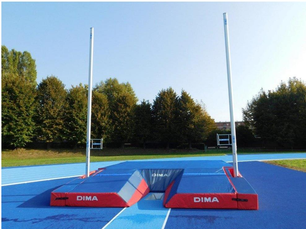
Zone d'atterrissage "International single cover" pour le saut à la perche, en mousse de polyuréthane à densité variable. Doublure unique en PVC solide avec système de maille périmétrique pour la ventilation. Finition supérieure en filet anti-ongles; complète avec protection pour rails droits. Dimensions cm. 800x600x80 / ??50; Couleur bleu / rouge. Approbation de l'IAAF avec la certification N ° E-99-0076.
