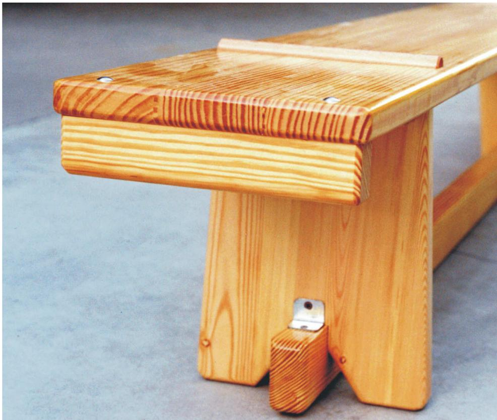
Banc de gymnastique suédois en bois avec balancier, 4 mt. Construit entièrement en bois naturel vernis, épaisseur mm.47; Longueur du plan en bois cm.400, largeur cm.30, 3 pieds au sol, petits barres transversaux appliqués sous le banc; Axe de la section d'équilibre mm.95x47. Longueur du banc cm.400.
