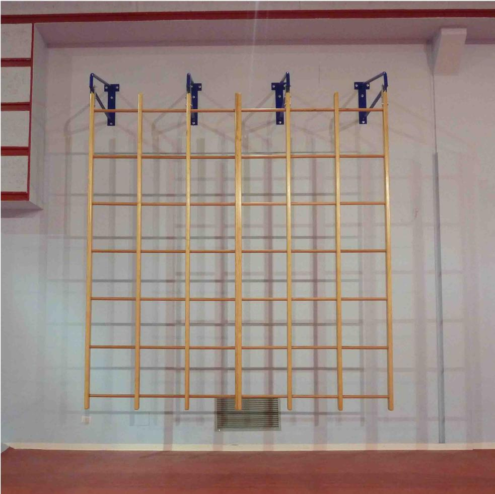
Barre suédoise à paroi 36 trous (6x6). Étagères de support en tube d'acier avec plaque à fixer au mur par des ponts, des pièces supérieures en bois épais mm.90x45 et des échelons en hêtre diam.mm.35, dim.cm.335x350 hauteur.
