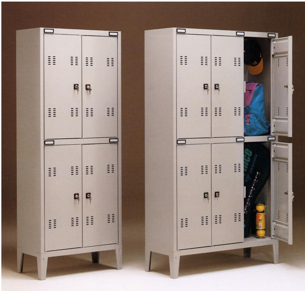
Structure portante en tôle 7/10 formée à froid peinte par galvanoplastie anodique en couleur gris RAL 7038. Portes montées sur charnières anti-effraction internes, équipées de fentes pour la ventilation interne. Dans chaque compartiment 4 patères, porte-étiquette standard, portes colorées sur demande .
