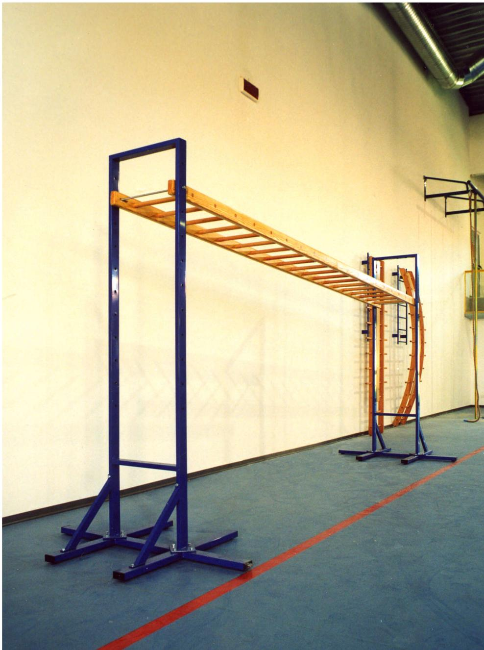
Échelle horizontale en bois sur support en acier, 5 mt de longueur, composée de 1 escalier en bois , structure en bois mm.90x50, échelons en hêtre diam.mm.35 largeur cm.50, longueur cm.500, deux cadres en acier peint les supports, les trous sur le cadre permettent de réguler la hauteur et l'inclinaison. Grande stabilité et sécurité.
