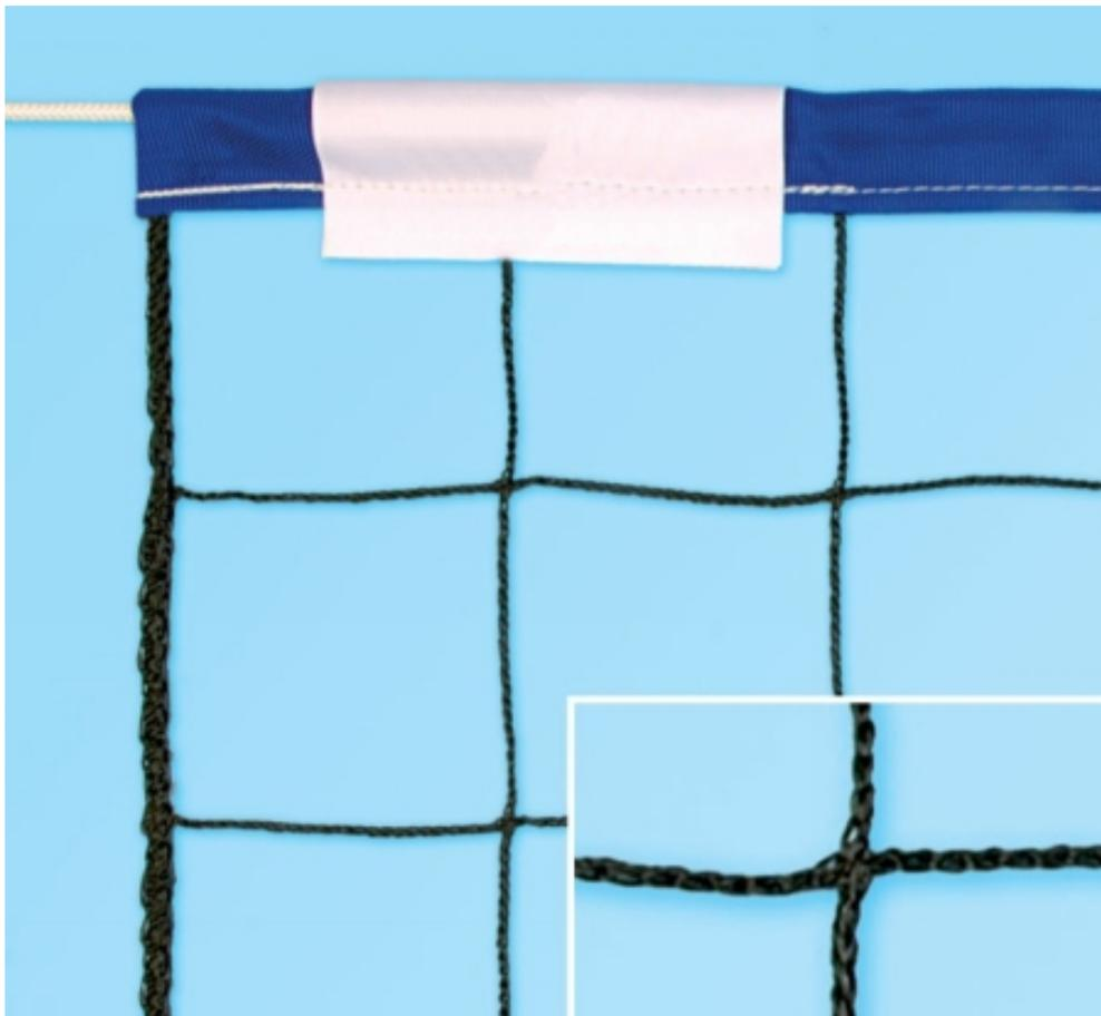
Filet Super Minivolley en tresse polyéthylène haute ténacité, stabilisé aux UV, travaillé sans nœud. Bande supérieure en polypropylène 40 mm. Cordes en nylon Ø 6 mm supérieures et inférieures pour la traction.
