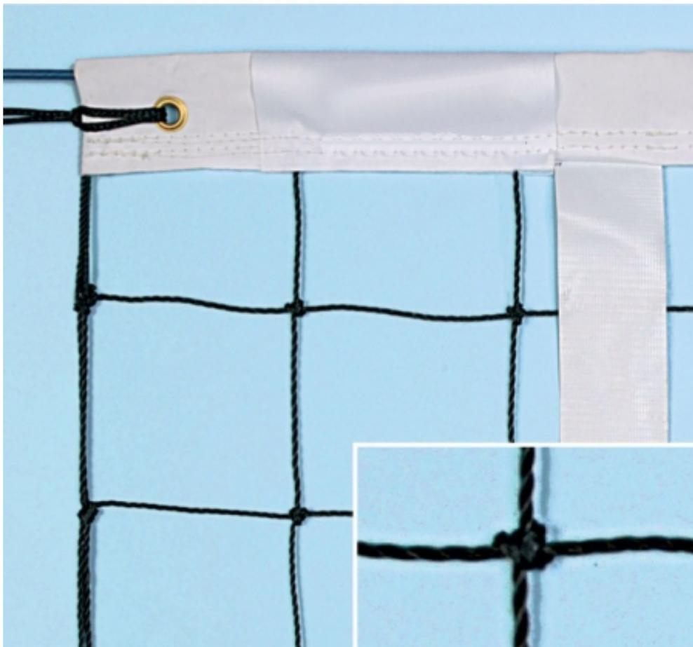
Filet de volley-ball en corde torsadée en polyéthylène stabilisé aux UV, hydrofuge, thermofixé, noué. Dans la partie supérieure, bande PVC haute ténacité 50 mm fixée avec double couture et câble en acier galvanisé Ø 5 mm recouvert de PVC. En partie basse, corde polyéthylène haute ténacité Ø 6 mm. Oeillets aux coins pour la traction. Bandes PVC fixes pour signaler la zone de jeu réelle.
