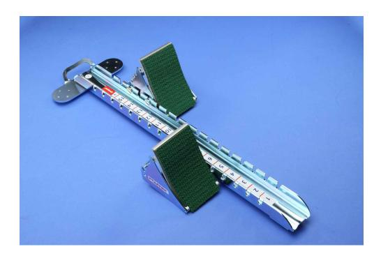
Omologato IAAF, struttura centrale in acciaio con longherone centrale graduabile su 32 posizioni, ceppi in acciaio regolabili in inclinazione su 4 posizioni e rivestiti in gomma sintetica.omologato w.a. con certificazione**e-09-0583**
