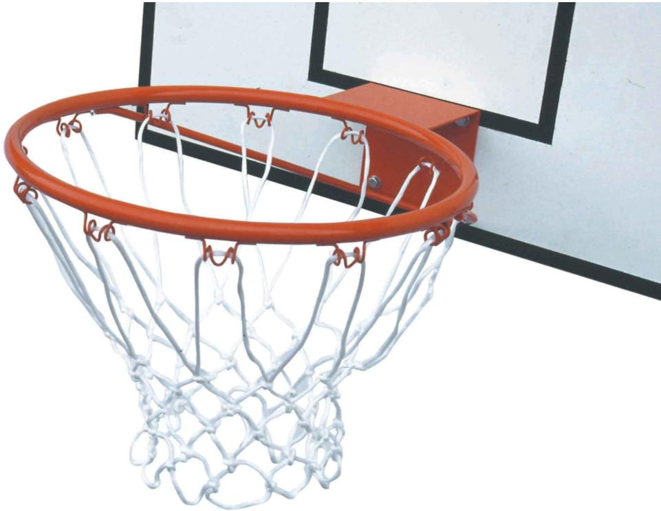
Canestro regolamentare in acciaio verniciato arancio bucciato, anello diam.mm.20x1,5 spessore,piastra con spessore mm.3 e larghezza mm.150 x150, 12 ganci diam.3mm, tirante diam. 10 mm.
