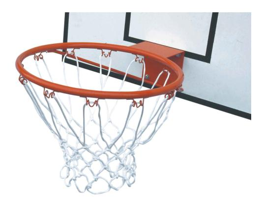
Canestro regolamentare rinforzato pesante in acciaio verniicato arancio bucciato, anello diametro mm.20x2 mm, piastra con spessore di 3 mm. e larghezza mm. 150x150, 12 ganci diametro 4 mm, tirante diametro 10 mm.interasse fori mm. 110x115, la differenza con l' art.4005 si basa su: la resistenza dei ganci essendo il diametro superiore ne assicura la resistenza alla rottura, l' anello spessore 2 mm. garantisce un' ottima saldatura con il gancio.
