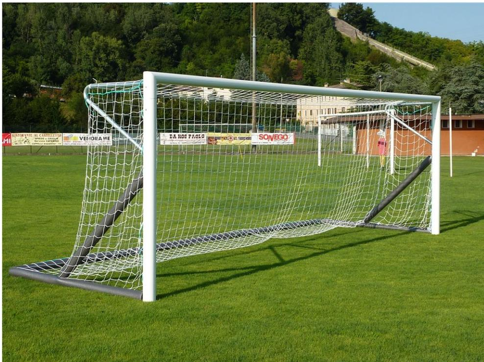
Paio **porte 6x2** metri, mobili, realizzata con profilo in **alluminio** sezione ovale 100x120 mm. con nervature interne. Per rendere la **porta** ancora più stabile e robusta i gomiti sono saldati e le giunzioni sono in profilo ad alto spessore in alluminio lega speciale 6005. **Reggirete** a gomito in acciaio zincato a caldo, e **ganci** in materiale plastico per il fissaggio della rete.
