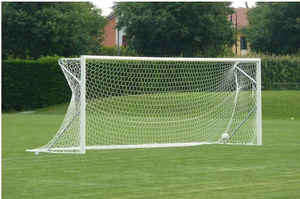
**Coppia porte mobili da calcio regolamentare 7.32x2.44 metri** realizzata con profilo in **alluminio** sezione ovale 100x120 mm. con nervature interne. Per rendere la porta ancora più stabile e robusta i gomiti sono saldati e le giunzioni sono in profilo ad alto spessore in alluminio lega speciale 6005.
