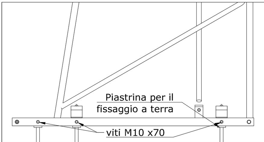
Fissare i 4 supporti per il trasporto e le piastrine per il fissaggio a terra alla base del traliccio con viti M10x70
