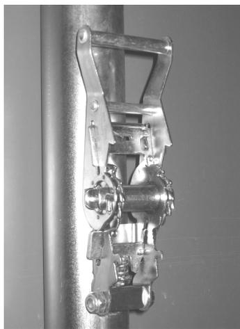
Per togliere o diminuire la tensione del nastro, tenere premuto la lamella dell'argano verso il basso e spostare la leva verso l'alto come nel disegno. Poi afferrare il nastro e tirare per sfilarlo.
