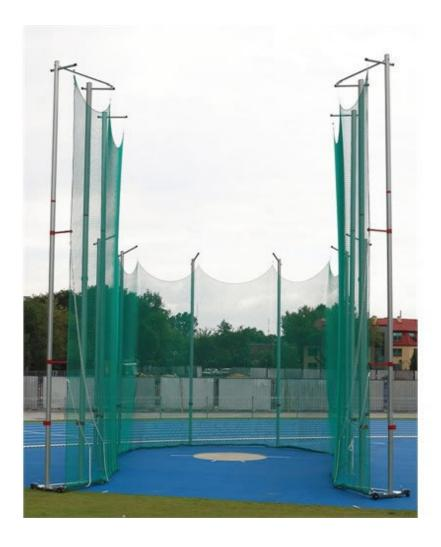
Gabbia zincata a caldo conforme all' attuale regolamento laaf, altezza pali mt.7, corridoio finale e cancelli alt.mt.10. struttura in tubo di acciaio zincato a caldo diametro mm.83 completa di doppie carrucole per l' innalzamento della rete di protezione. Pali perimetrali di altezza cm.700 fuori terra e uniti tra loro da distanziali superiori in modo da alimentare la stabilita'. Cancelli anteriori apribili e scorrevoli su ruote, altezza mt.10 fuori terra.
