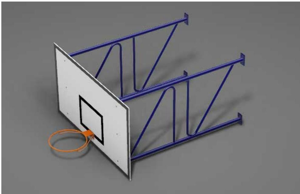
Impianto basket a parete, fisso, tabellone in legno 180x105 cm.. Struttura in tubolare di acciaio verniciato da fissare mediante tasselli, composta da 4 tralici controventati, robusta sezione da mm.50, sbalzo cm.168, Completo di tabelloni in legno misure cm.180x105, canestri e retine, con telaio porta tabellone per una maggiore robustezza.
