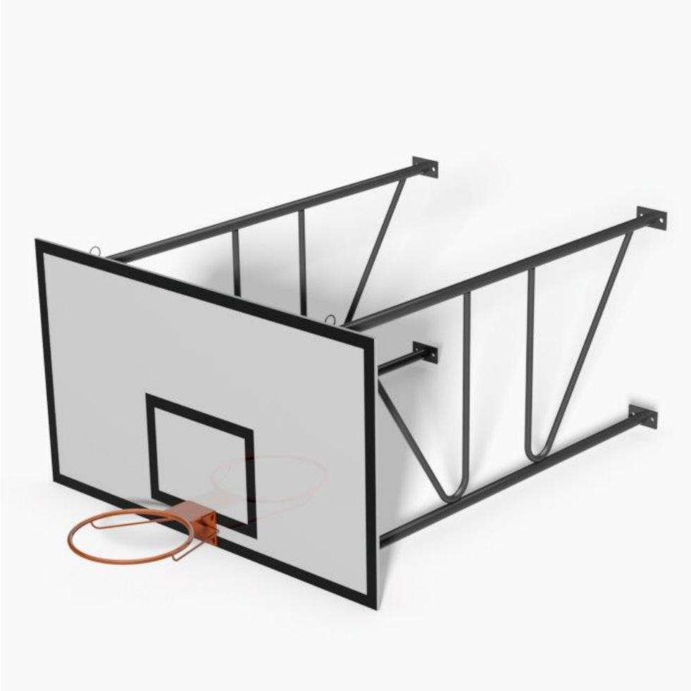
Impianto basket a parete, fisso, tabellone in legno 180x105 cm.. Struttura in tubolare di acciaio verniciato da fissare mediante tasselli, composta da 4 tralici controventati, robusta sezione da mm.50, sbalzo cm. 320, Completo di tabelloni in legno misure cm.180x105, canestri e retine.
