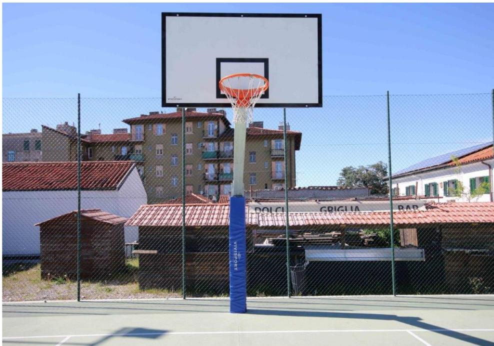
Struttura in tubolare di acciaio zincato a caldo **sezione cm. 15x15, sbalzo cm. 165**, completo di piastra di fissaggio a terra, **tabelloni regolamentari in legno cm.180x105** serigrafati colore bianco/nero, telaio di sostegno tabelloni in acciaio zincato a caldo, canestri e retine regolamentari.
