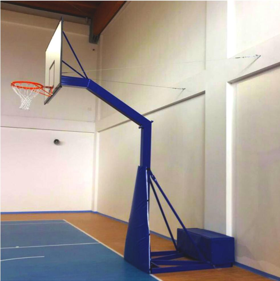
Impianto monotubo trasportabile, tabellone legno struttura pesante, supporto portante del tabellone in tubo quadro mm. 150x150; tiranti di rinforzo in tubo rotondo diam. mm. 40; il tutto fissato e rinforzato per ridurre le vibrazioni del tabellone;
