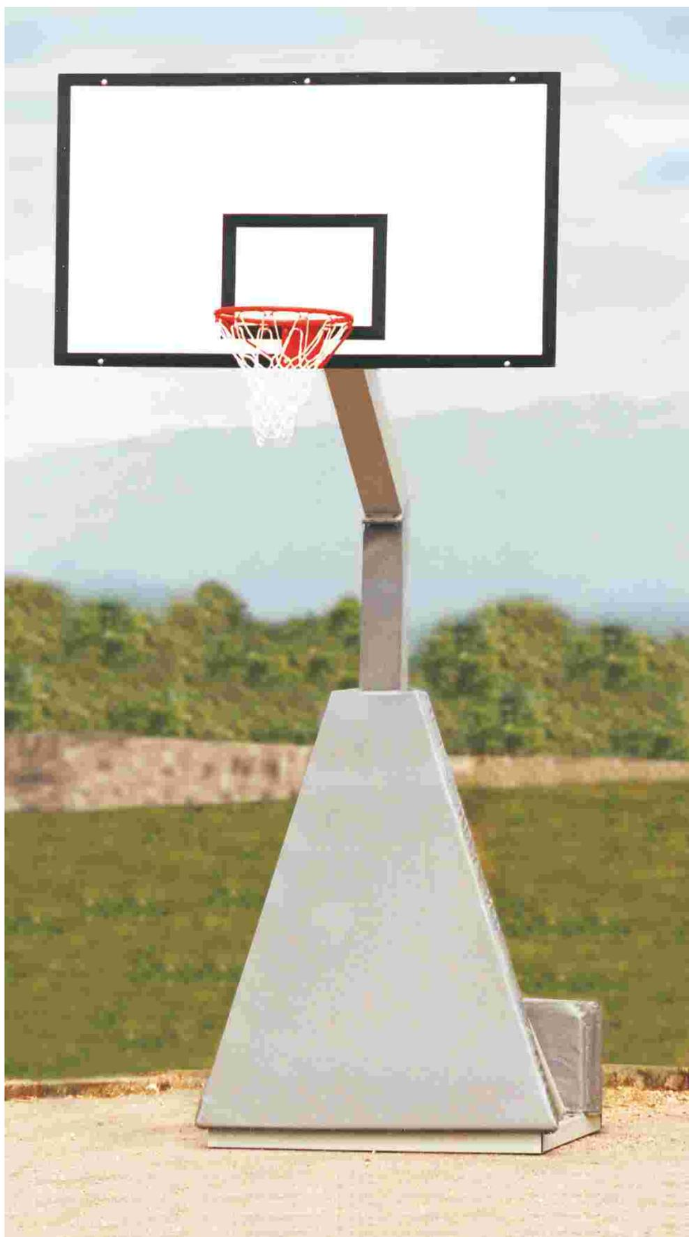
Impianto monotubo trasportabile, tabellone in resina melaminica struttura pesante, supporto portante del tabellone in tubo quadro mm. 150x150; due tiranti di rinforzo in tubo rotondo diam. mm. 40; il tutto fissato e rinforzata per ridurre le vibrazioni del tabellone; l'impianto è dotato di un sistema particolare di aggancio del telaio al tabellone, tale da renderlo regolabile in altezza e inclinazione, adattandolo a pavimenti non livellati; sul retro della struttura a terra
