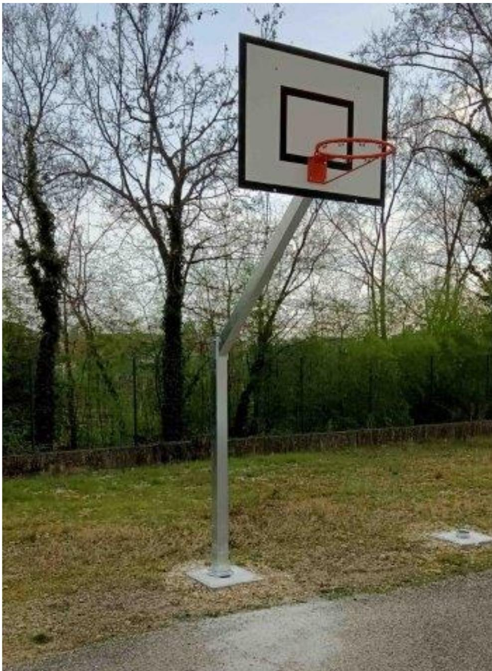
Struttura in tubolare di acciaio zincato a caldo sezione cm. 10x10, sbalzo cm.120, fissaggio con piastra, tabelloni 120x90 cm in resina melaminica serigrafati colore bianco/nero, telaio di sostegno tabelloni in acciaio zincato, canestri e retine regolamentari. Tutti i componenti vengono forniti smontati per facilitarne il trasporto, in fase di montaggio si può scegliere l'altezza di gioco desiderata minibasket/basket.
