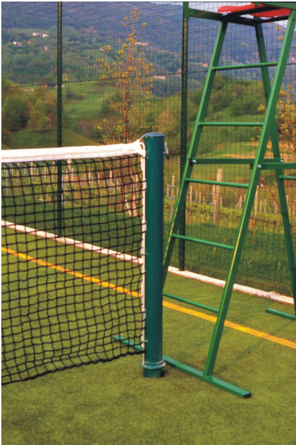
Impianto tennis acciaio sezione rotonda costruito con tubi in acciaio zincato a caldo e verniciato diam. mm.90x2completi di argano tendirete, attacco della rete al palo mediante astina che si infila verticalmente in tutte le maglie della rete in modo da non danneggiare i bordi, fissaggio al terreno mediante bussole.
