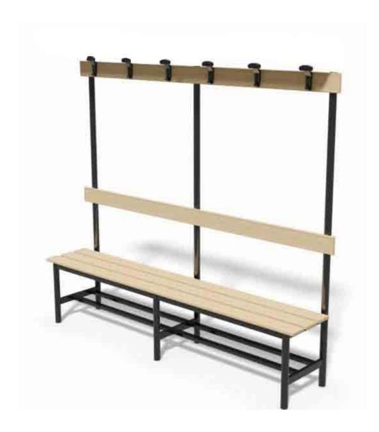
Panca spogliatoio con seduta, schienale e appendiabiti, lunghezza 2 metro, struttura verniciata realizzata con montanti in acciaio sezione rotonda diam. 40 e traversini in acciaio sezione rettangolare 40x20 mm.. Dotata di ripiano portascarpe, listoni di legno massiccio verniciato al naturale, piendini antiscivolo, tappi di chiusura sui terminali dei tubi. Appendiabiti con 3 grucce.
