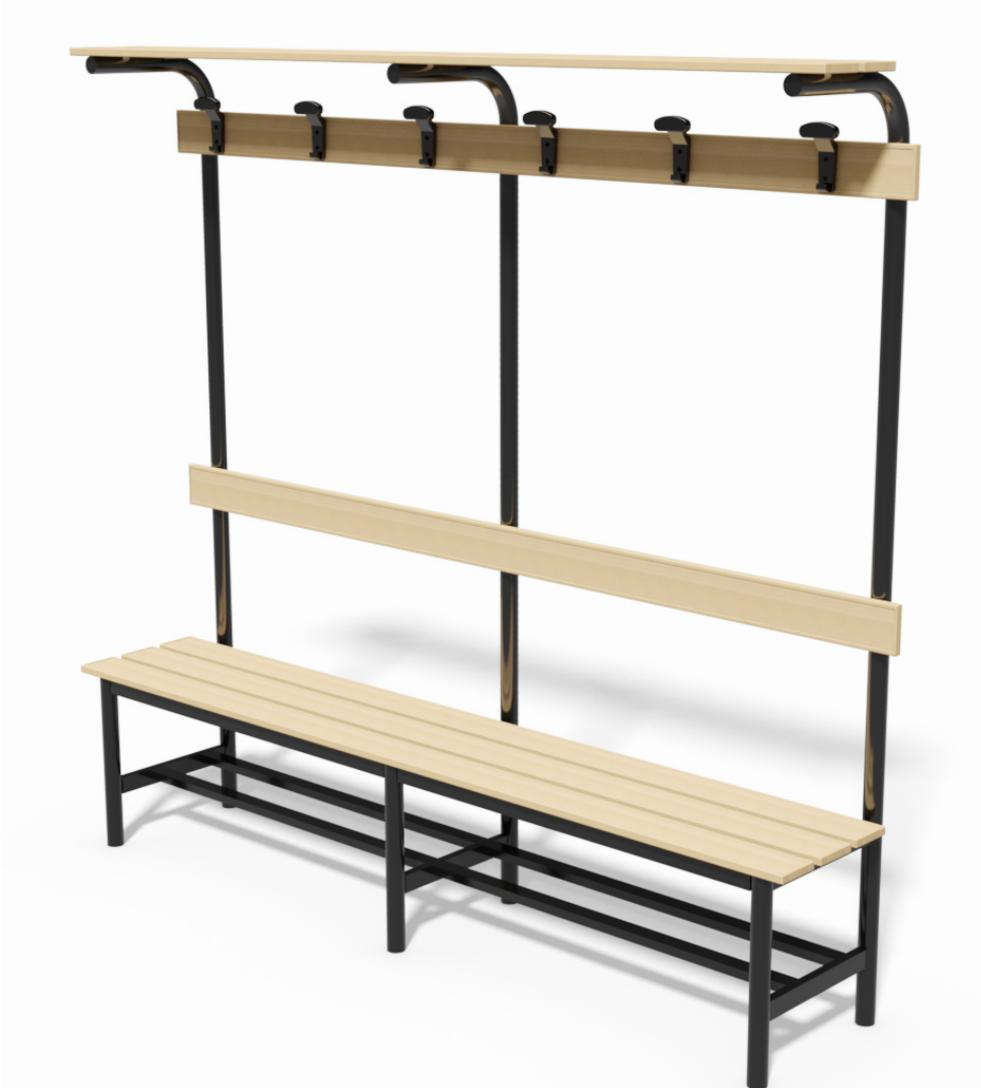
Panca spogliatoio con seduta, schienale, appendiabiti e piano poggia borse, lunghezza 2 metri, struttura verniciata realizzata con montanti in acciaio sezione rotonda diam. 40 e traversini in acciaio sezione rettangolare 40x20 mm.. Dotata di ripiano portascarpe, listoni di legno massiccio verniciato al naturale, piendini antiscivolo, tappi di chiusura sui terminali dei tubi. Appendiabiti con 6 grucce.
