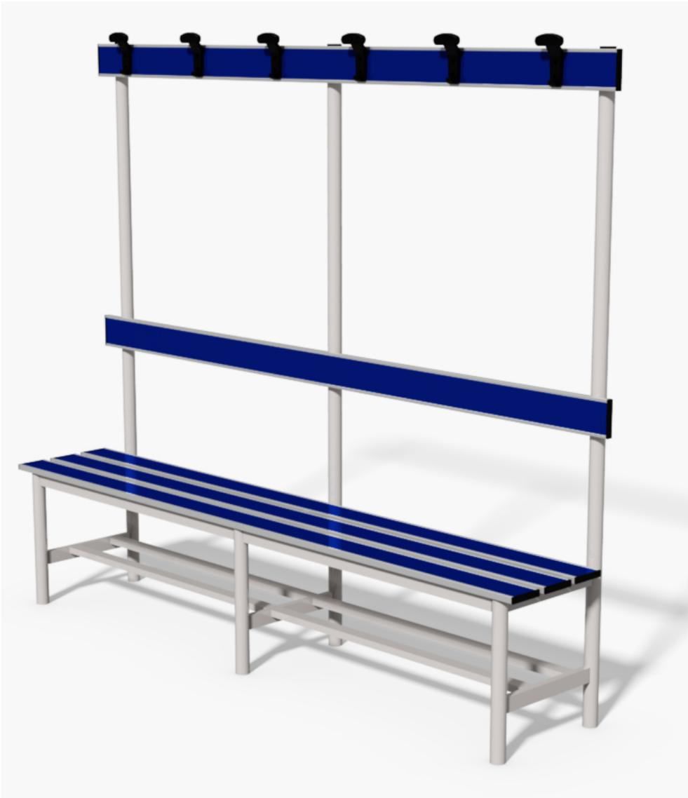
Panca spogliatoio con seduta, schienale e appendiabiti, lunghezza 2 metro, struttura realizzata con montanti in alluminio sezione rotonda diam. 40 e traversini in alluminio sezione rettangolare 40x20 mm.. Dotata di ripiano portascarpe, doghe in alluminio anodizzato con inserto in pvc colore blu, piendini antiscivolo, tappi di chiusura sui terminali dei tubi. Appendiabiti con 3 grucce.
