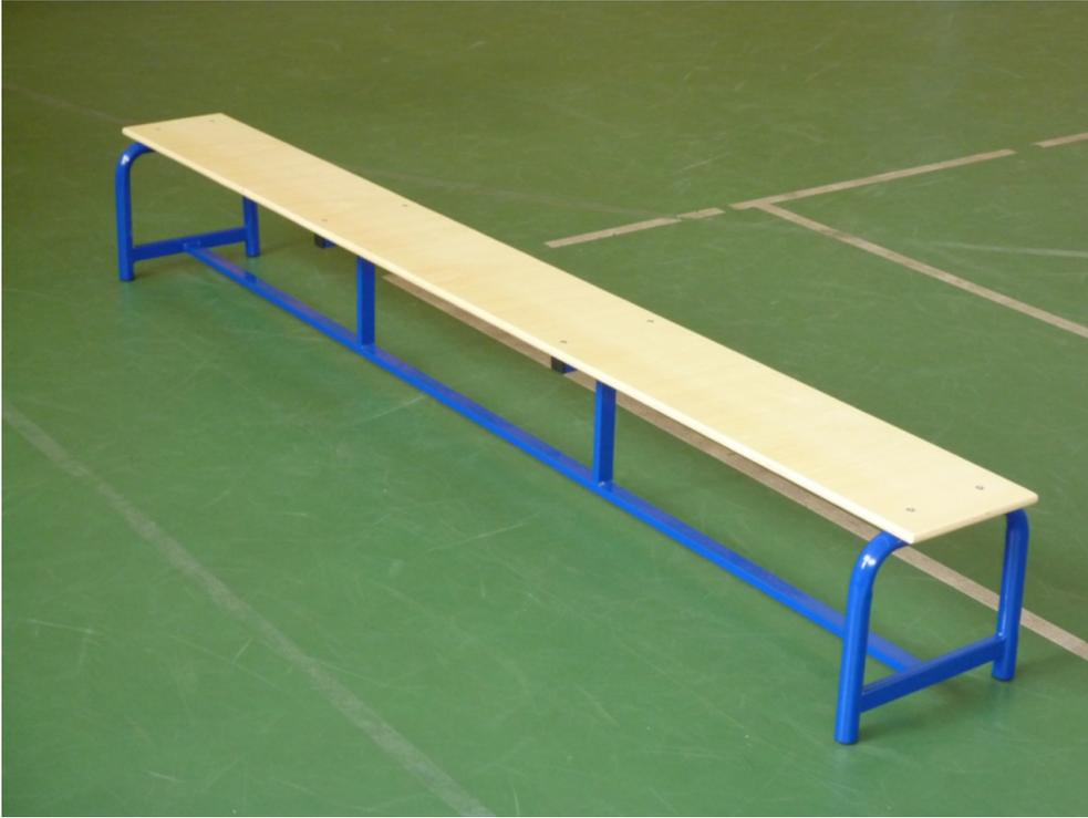
Panca svedese senza asse di equilibrio in legno, struttura tubo di acciaio verniciato  $\varnothing$  40 mm., piano in legno lunghezza cm 300, larghezza cm.30, spessore mm.20, altezza da terra cm.40.
