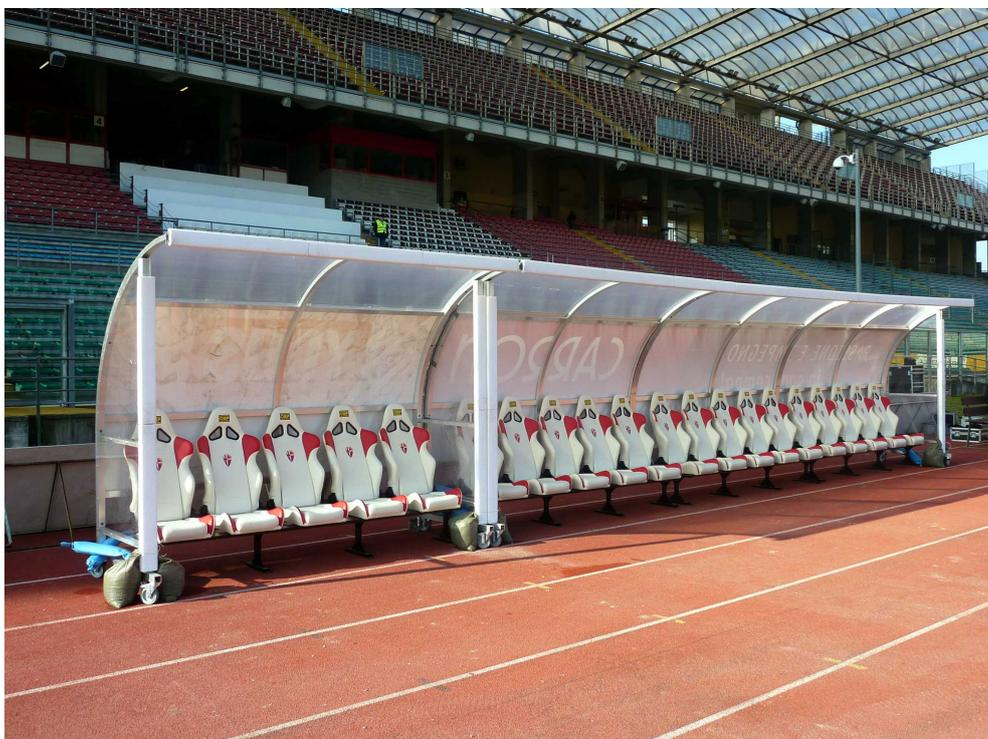
Panchina modello "Strong Plus" da 6 metri (12 posti), coperte e fianchi realizzati completamente in alluminio con montanti frontali antinfortunistici a sezione maggiorata 60x70 mm.. Copertura in policarbonato alveolare semitrasparente spessore 4 mm. Telaio sedute in acciaio zincato a caldo e scocche in polipropilene con schienale. Rispetto alla panchina "Strong", la "Strong Plus" ha una profondità maggiore.
