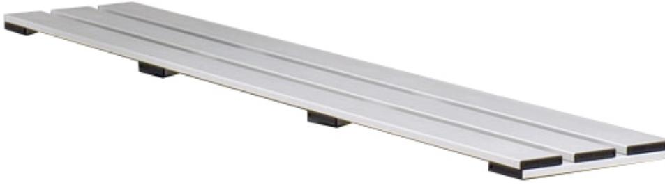
Pedana poggiapiedi in alluminio anodizzato da mt.2 costruita interamente in doghe di alluminio anodizzato colore grigio zigrinate per un migliore grip, 3 assi larghezza mm.100 spessore mm.18 collegate e rivettate con 2 spezzoni delle stesse dimensioni, tappi antiscivolo posti a terra.
