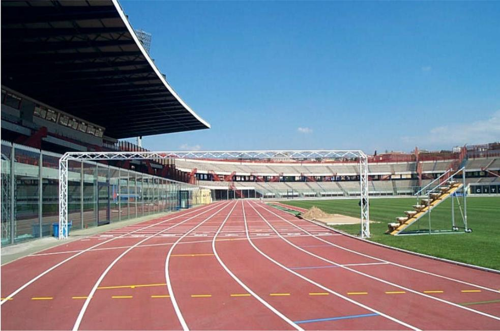
Struttura in tubolare realizzato in alluminio anodizzato di misure regolamentari completo di basi per il fissaggio su plinti in cls mediante tasselli (tasselli esclusi), struttura reticolare a sezione triangolare a resistenza completo di N°6 agganci per fari, escluso di lampade ed allacciamenti, dimensione L=10m Alt=3m.
