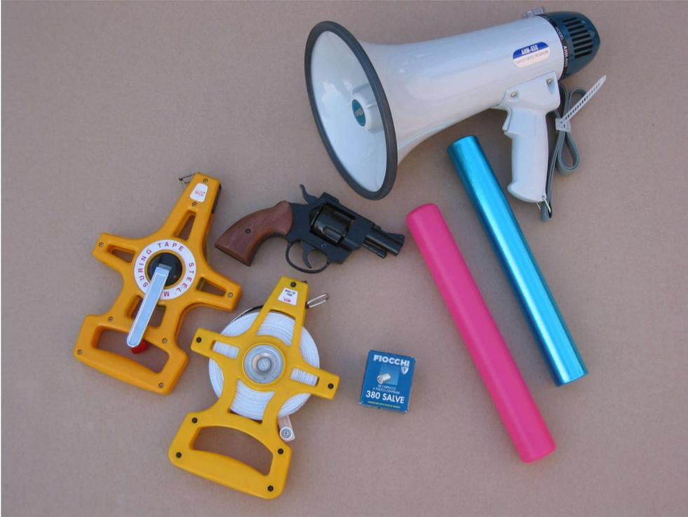
Rotella metrica in acciaio da mt.20 nastro in acciaio centimetrato, smaltato, impugnatura in plastica resistente e manovella per avvolgere il nastro.
