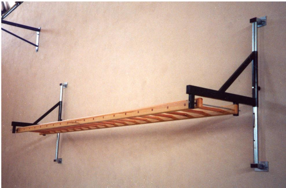
Scala orizzontale a parete da mt.5 completamente in legno con longheroni da mm.90x50 e pioli diam.mm.35, lunghezza mt.5, larghezza cm.50, posta su mensole in acciaio verniciato e zincato da fissare a parete mediante tasselli.
