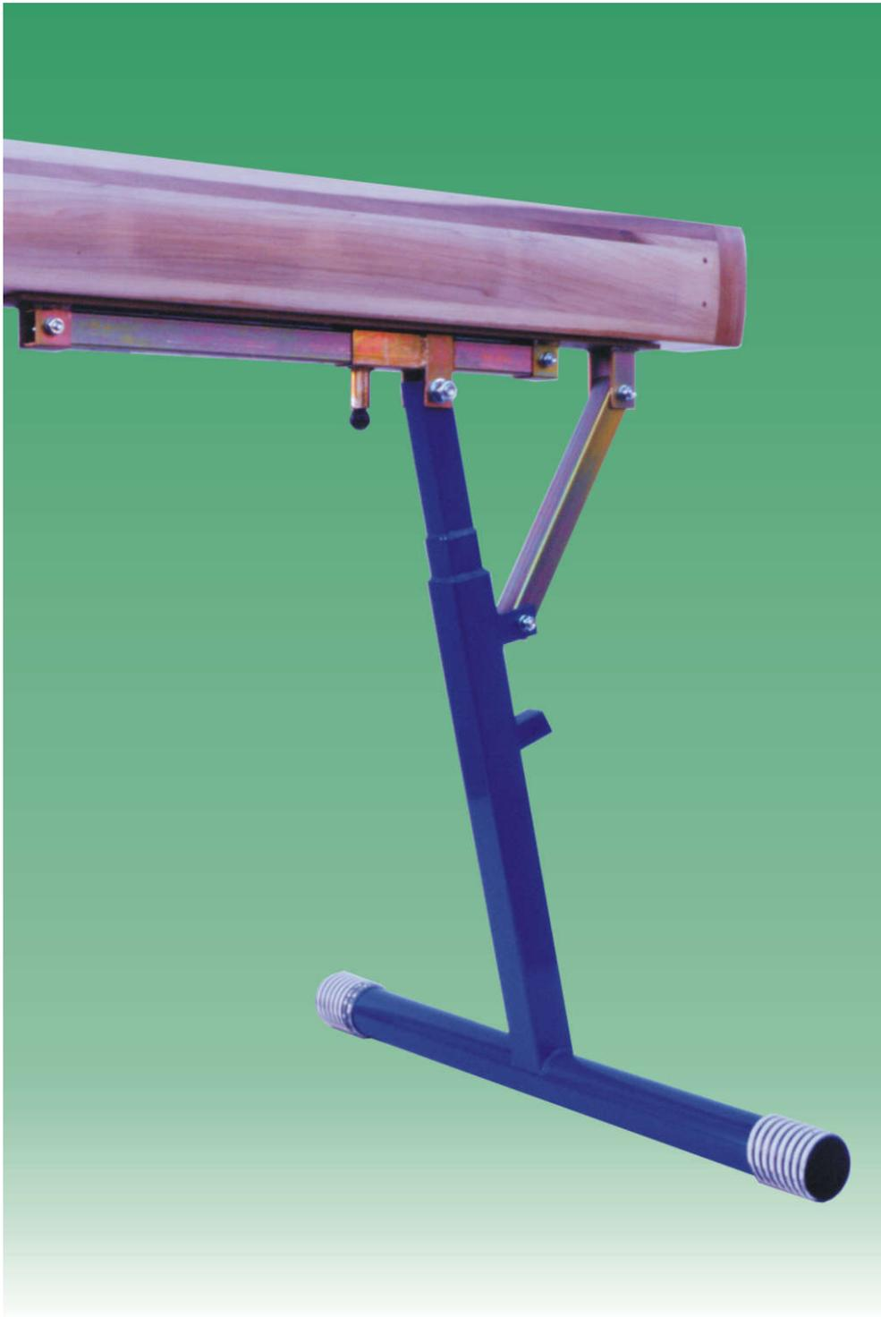
Trave di equilibrio femm. grad. cm.55-120 modello regolamentare; costituita da trave in legno verniciato lunghezza mt.5, sezione cm.13x16 con fianchi bombati e da 2 supporti in acciaio zincato e verniciato regolabili in altezza mediante ricerca automatica a scatto. punti di appoggio gommati antiscivolo altezza regolabile da cm.52 a cm.120
